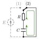
• Lorsqu'il est en position (2), le condensateur se décharge dans le résistance R.
