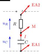
• On commence les premières mesures avec un condensateur de capacité  $C=4\,700~\mu\mathrm{F}$  et un conducteur ohmique de résistance  $R=100~\Omega$ .
