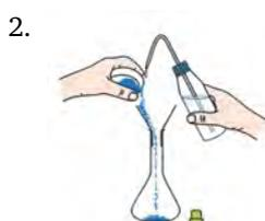
3. Compléter avec de l'eau distillée jusqu'à mi-parcours, afin de permettre une agitation ultérieure vigoureuse et donc une meilleure dissolution. Dissoudre le solide en agitant vigoureusement sans retournement ;
