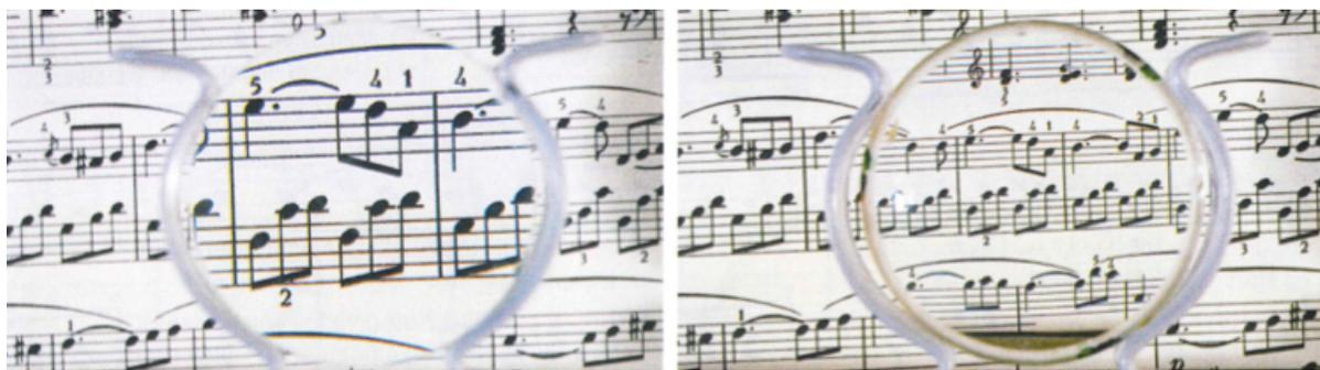
**Expérience** Observer un texte posé sur la table au travers d'une lentille convergente puis au travers d'une lentille divergente. Noter vos observations :
