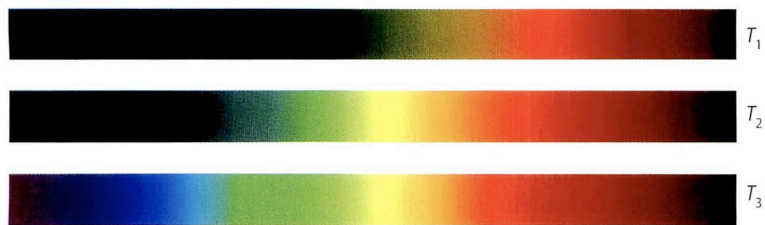
FIG. 3 – Spectres d'émission d'un filament dont la température augmente ( T_3 > T_2 > T_1 ).
