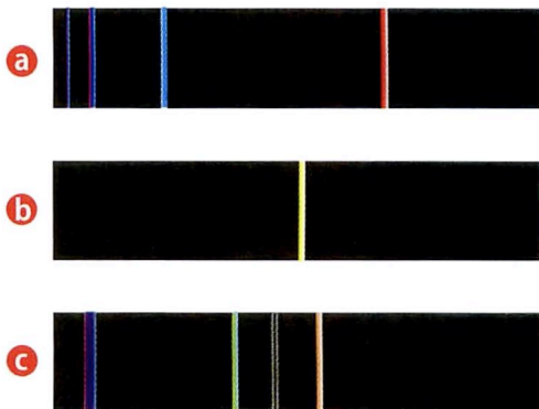
FIG. 5 – Spectres d'émission de lampes à décharge électrique contenant un gaz (Ⓐ hydrogène) ou des vapeurs métalliques (Ⓑ sodium et Ⓒ mercure).
