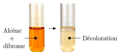
FIG. 1 – Test caractéristique d'un alcène.
