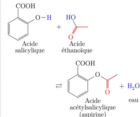
Lors de cette réaction, un atome d'hydrogène (en bleu H) de l'acide salicylique est remplacé par le groupe d'atome acétyle (en rouge) :
