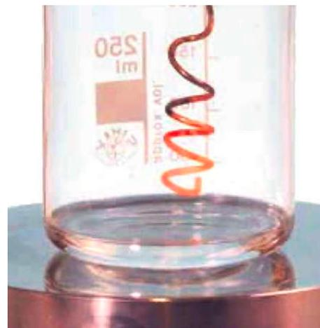
FIG. 2 – Tortillon de cuivre rougeoyant au-dessus des vapeurs d'alcool.
