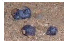
FIG. 6 – Particules d'oxyde de fer au fond du flacon.
