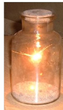
FIG. 5 – Combustion du fer dans le dioxygène.
