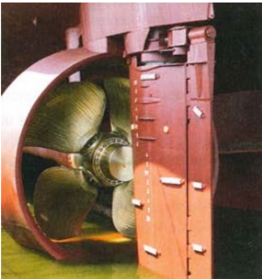
FIG. 1 – Pièces en zinc sur la coque d'un bateau.
