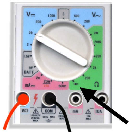
FIG. 26 – Test d'une diode. Bien noter le branchement des fils et la position du commutateur.
