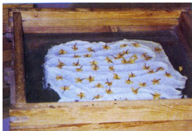
FIG. 1 – Un châssis d'enfleurage. Les produits à traiter sont déposés à même la couche de graisse.
