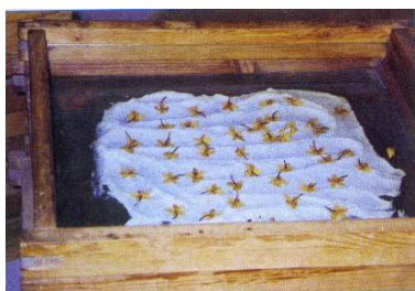
FIG. 1 – Un châssis d'enfleurage. Les produits à traiter sont déposés à même la couche de graisse.
