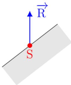
FIG. 2 – Réaction  $\vec{R}$  du support modélisant l'action de la pente enneigée sur un skieur S immobile.
