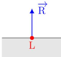
FIG. 1 – Réaction  $\vec{R}$  du support modélisant l'action de la table sur le livre L qui y est posé.
