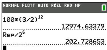
On remarque alors que l'on ne retombe pas exactement sur l'octave à 200 Hz : en multipliant par  $3/2$  et en divisant par 2 autant de fois que nécessaire, on ne peut pas reproduire le facteur 2 exact nécessaire pour obtenir une octave qui sonne juste. Il s'agit du fameux problème de la douzième quinte qui sonne faux, ou *quinte du loup*.
