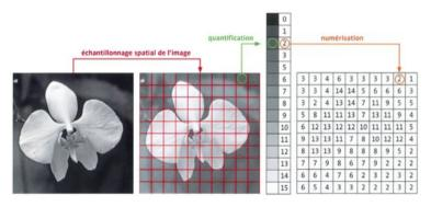
L'intensité lumineuse, grandeur analogique, est convertie par la cellule en un signal analogique sous forme de tension électrique. Elle est ensuite quantifiée, puis numérisée. À chaque valeur d'intensité lumineuse correspond un niveau de gris codé numériquement.
