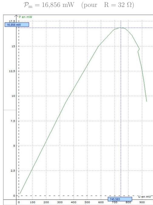
FIG. 6 – Courbe  $\mathcal{P} = f(U)$  et mesure de la puissance maximale, extremum de cette courbe.
