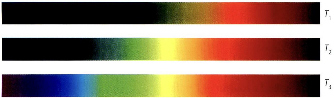
FIG. 3 – Spectres d'émission d'un filament dont la température augmente ( T_3 > T_2 > T_1 ).
