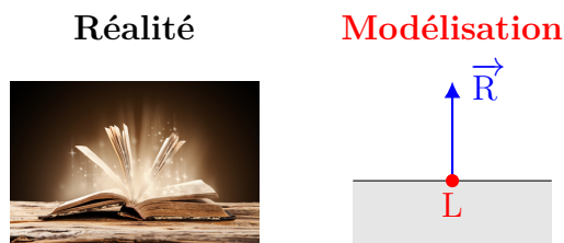
FIG. 1 – Réaction \vec{R} du support modélisant l'action de la table sur le livre L qui y est posé.
