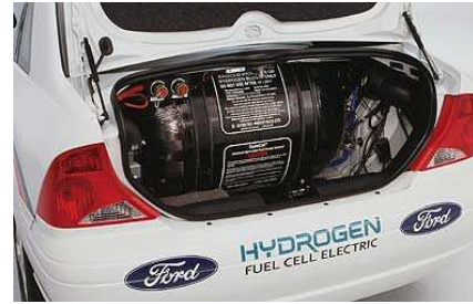
FIG. 4 – Réservoir de dihydrogène sous pression à l'arrière du véhicule.
