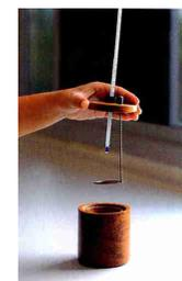
Le calorimètre est thermique isolé (comme une bouteille thermos) : on considère qu'il n'y a aucun transfert d'énergie entre lui et le milieu extérieur.
