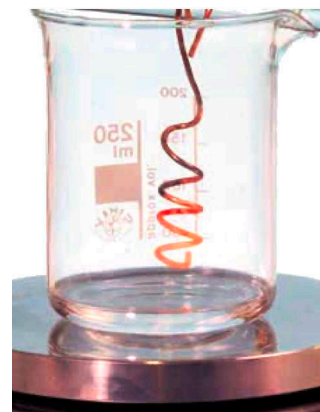
FIG. 2 – Tortillon de cuivre rougeoyant au-dessus des vapeurs d'alcool.
