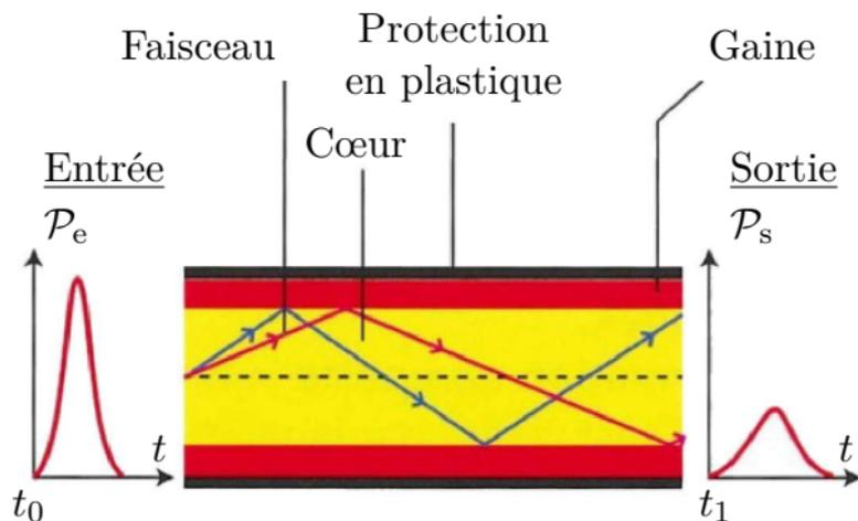
FIG. 3 – Fibre à saut d'indice
