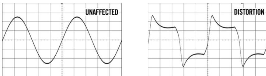
FIG. 8 – Distorsion d'un signal.
