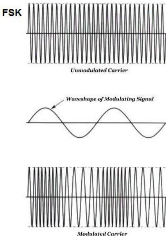
FIG. 7 – Modulation de fréquence.
