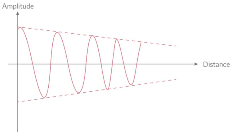
FIG. 10 – Atténuation du signal.
