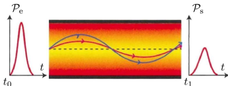
FIG. 4 – Fibre à gradient d'indice
