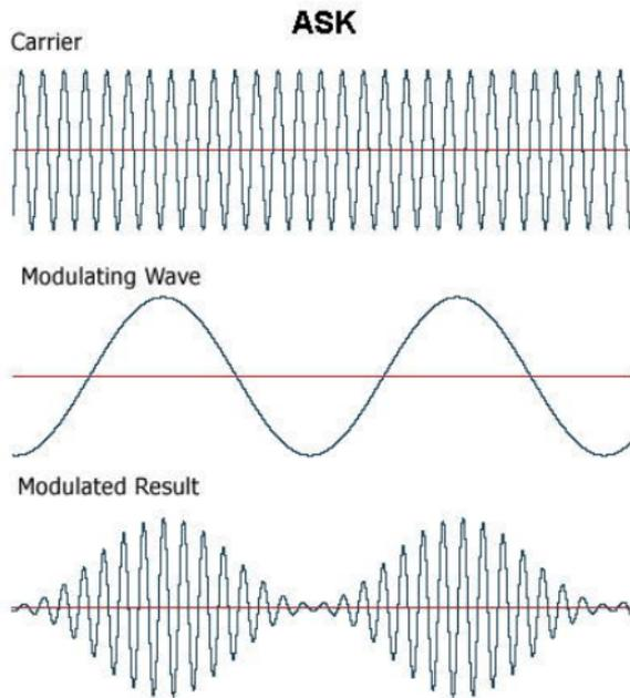
FIG. 6 – Modulation d'amplitude.
