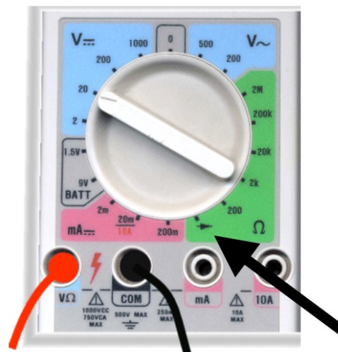
FIG. 8 – Test d'une diode. Bien noter le branchement des fils et la position du commutateur.
