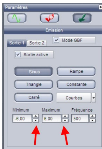
FIG. 21 – Réglage de l'amplitude du GBF
