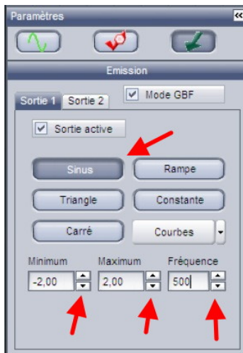
FIG. 14 – Forme et amplitudes du signal de sortie.
